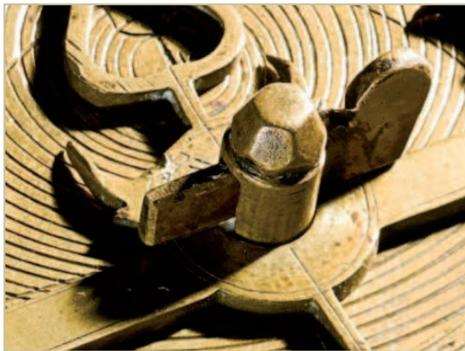
Рис. 7. Ось и шплинт-«лошадка» астрлябии Д. Кинга
