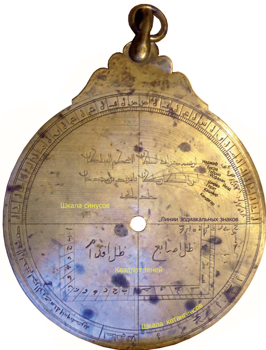
Рис. 3. Обратная сторона астролябии (пояснительные надписи сделаны мной. – С. М.)
