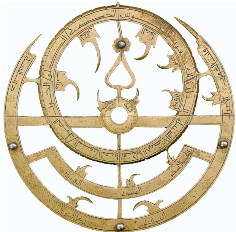
Рис. 6. «Паук» астрлябии, описанной Д. Кингом. Примерно так должен был выглядеть «паук» астрлябии из РНБ
