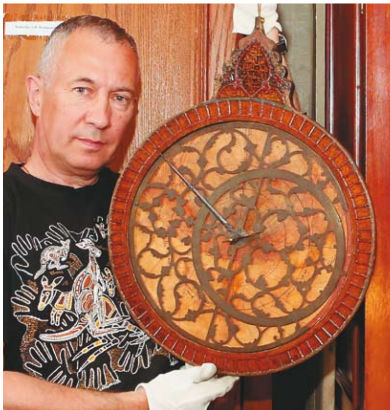
Сергей Юрьевич Масликов с астрольбией VP-856. На лицевой стороне астрольбии виден ажурный паук с эклипстикой и звёздами. Он латунный. Под ним находятся 8 тимпанов, вырезанных из картона, а ещё дальше, на самом дне — географический справочник.
