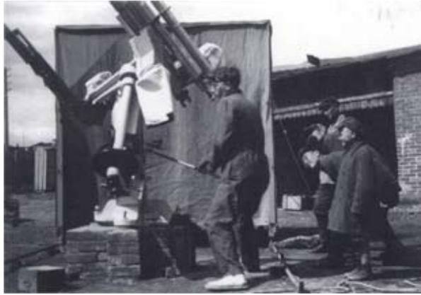
установлено оборудование французской экспедиции. На одну монтировку смонтировали всю имеющуюся аппаратуру – телескоп-гид, фотокамера с призмой Волластона, три спектрографа и коронограф.
