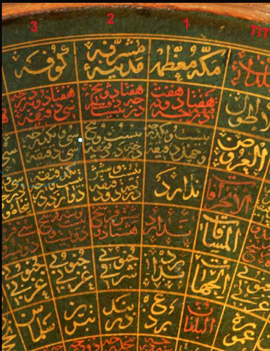
• Фрагмент географического справочника на корпусе большой астрольбии из Эрмитажа. В столбце справа указаны обобщающие понятия: город, долгота, широта, азимут направления на Мекку, расстояние до Мекки в фарсах, сторона горизонта. Рядом данные по трём городам: Мекке (до неё расстояние равнялось нулю), Медине, Куфе.
