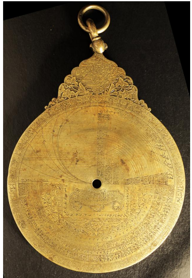
Рисунок А.3.1 – Корпус с географическим справочником (слева) и оборот астролябии № 3. В картуше под квадратом теней на обороте приведено имя декоратора: «Мухаммад Бакир Исфахани декорировал (намакаху)»
