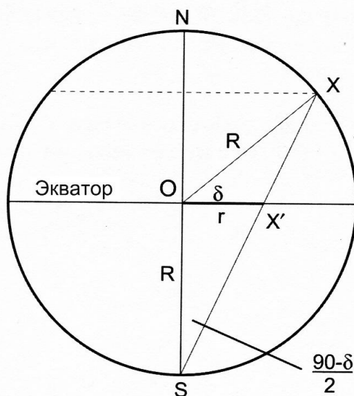
Рисунок 3.3 – Вывод основного уравнения стереографической проекции
