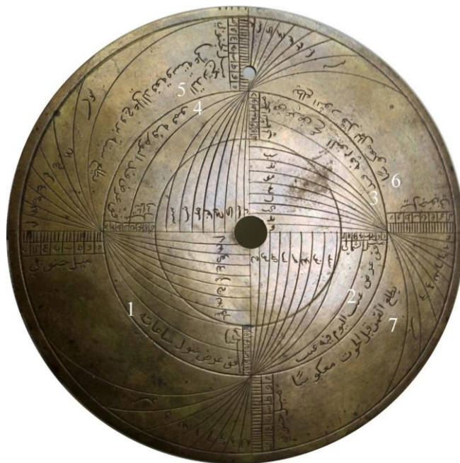
Рисунок А.9.4 – Пластина «всех горизонтов» астролябии № 9.
