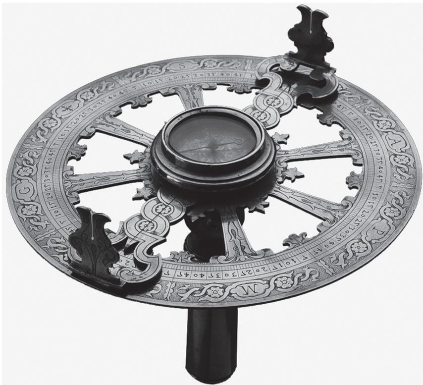
Рис. 2. Первый геодезический угломерный инструмент – «полный круг». Данный образец «Cercle entier» XVII в. хранится в Королевском музее искусства и истории (Musées royaux d'Art et d'Histoire) в Брюсселе, Бельгия
